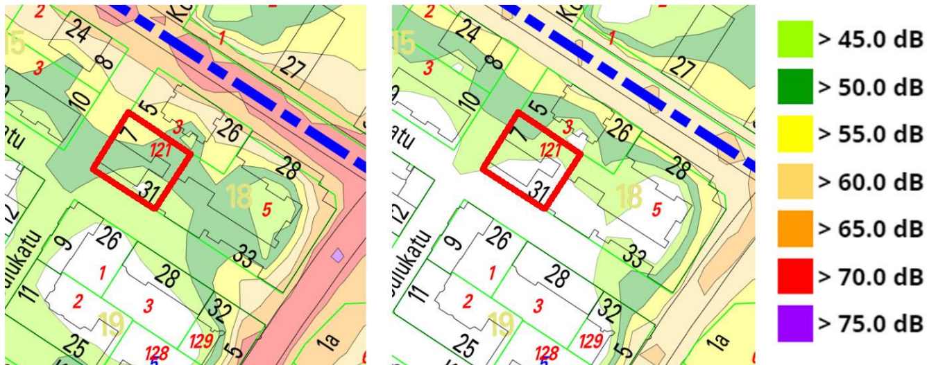
Kuvat 6 ja 7. Yhteismelu suunnittelualueella. Kuvassa 6 on esitetty päiväajan melu ja kuvassa 7 yöajan melu. Kuva: WSP Finland, 2018.
